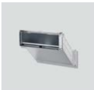
GU CL BD2 01 Scatola per montaggio da incasso in lamiera di acciaio zincata a fuoco. Per ogni frontalino deve essere ordinata una scatola adeguata. Nella tabella sono indicate le scatole corrispondenti. Dimensioni (mm) Larg. x Alt. x Prof.: 293 x 151 x 290-440
