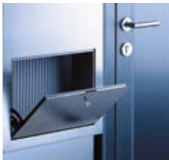
Pratica ricezione della posta: apertura in avanti per impedire che la posta possa cadere, cassetta in materiale plastico contro la formazione di condensa e fondo scanalato per evitare che la posta si bagni qualora dovesse penetrare acqua.
